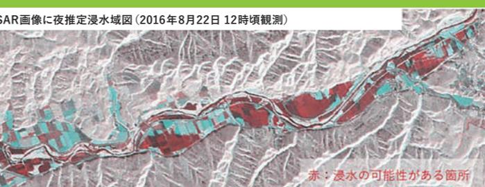
SAR画像による夜推定浸水域図 (2016年8月22日 12時頃観測)
