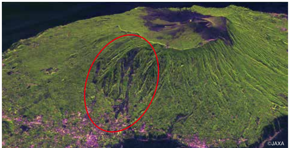
ALOS-2搭載PALSAR-2 (3m分解能) による伊豆大島の観測画像 (2014年6月19日) ※赤、緑、青にHH, HV, HH/HV偏波の各画像をそれぞれ割り当てた偏波カラー合成画像
