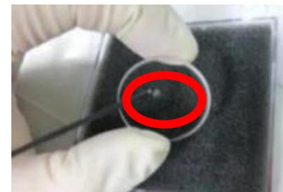
レーザー誘起コンタミネーション (LIC\*) 実験で発生した光学素子上に付着した物質
