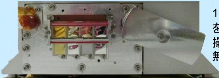
13種類の材料サンプルをカメラにより定期的に撮像。劣化や破れの有無をモニタ
