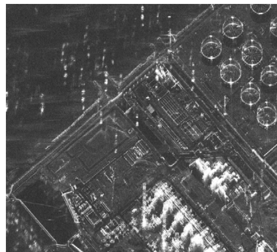
Kuバンド航空機 SARによる観測 画像例 分解能：0.5m
