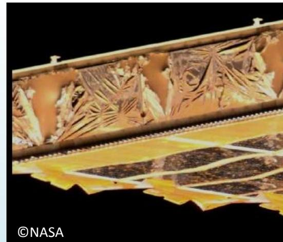
宇宙ステーション太陽電池パドル側面部の原子状酸素による劣化の様子
