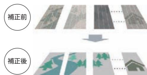
補正前：衛星センサ素子の感度によって測定結果にばらつきが生じ、ムラや線が入る場合があります。
