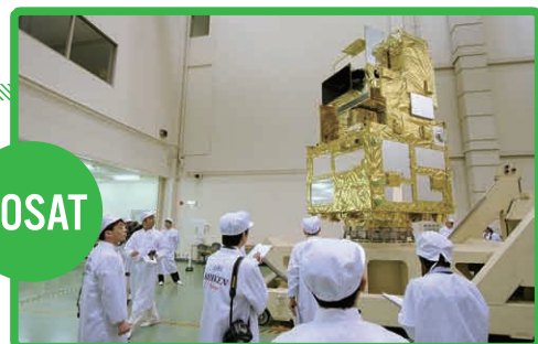
筑波宇宙センターで公開した熱構造モデルは、打ち上げ時の振動や過酷な宇宙環境での温度制御などを試験するモデルのこと。
