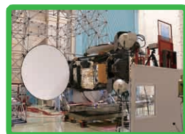
マルチビームアンテナの衝撃試験
