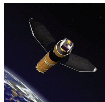
先端部分(フェアリング)が展開し、切り離す
