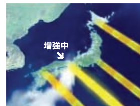
大阪へ雨雲がかかっている場合は、降雨による電波の減衰をカバーするため、大阪への送信出力を増強。
