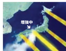
大阪へ雨雲がかかっている場合は、降雨による電波の減衰をカバーするため、大阪への送信出力を増強。
