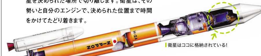
先端部分(フェアリング)が展開し、切り離す
