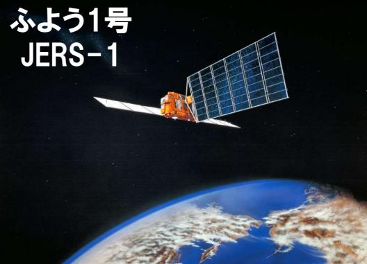
日本初のLバンド合成開口レーダ衛星
